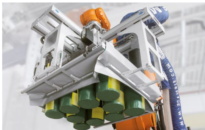
Vakuum-Lagengreifsystem SPZ bei der Handhabung von Eimern
