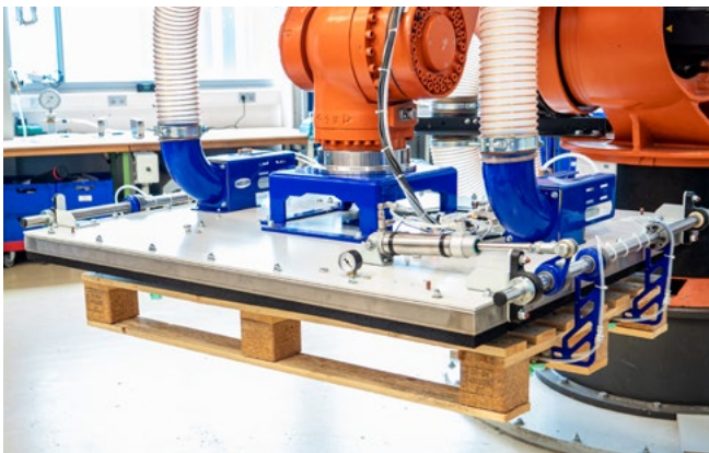
Lagengreifsystem mit Palettenklemmung und Zwischenlagenhandhabung
