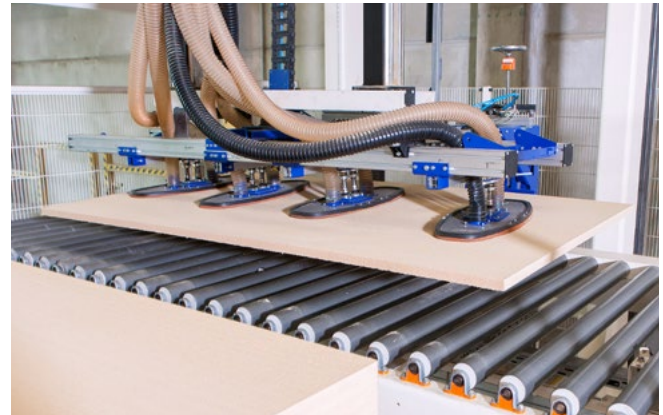
Saugspinne mit Saugplatten zur Handhabung von porösen Holzplatten
