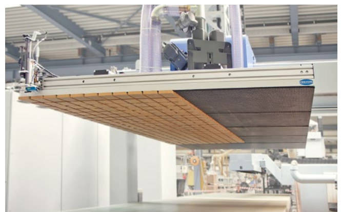
Lagengreifsystem zum Abstapeln von Werkstücklagen in der Nesting-Fertigung
