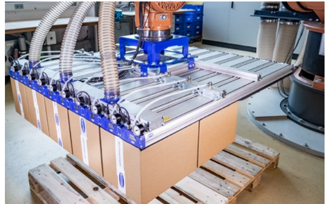
Lagengreifsystem aus verblockten Flächengreifern FMP zur Handhabung von Kartons
