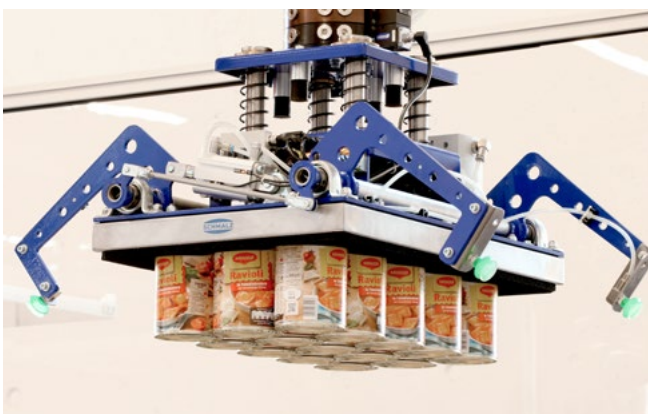
Lagengreifsystem mit Palettenklemmung und Zwischenlagenhandhabung zur Palettierung von Dosen
