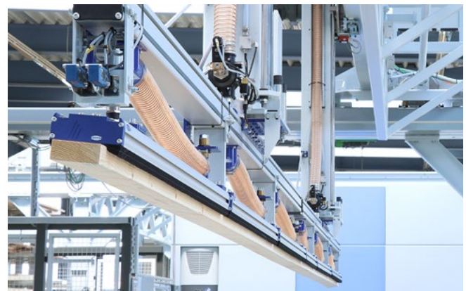
Saugspinne mit Flächengreifern FMP zur Beschickung einer Abbundanlage
