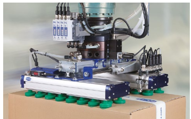
Saugspinne mit verstellbaren Greifern zur Separierung von Kartons
