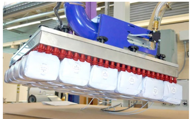
Lagengreifsystem mit Sauggreifern zur Handhabung von instabilen Zuckerpackungen
