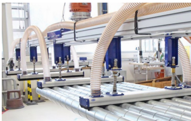
Saugspinne mit Flächengreifern FMP zur Handhabung von Rohren
