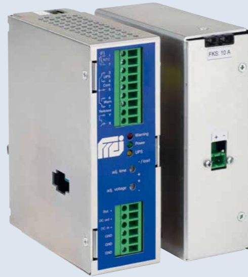
DC-USV-Modul mit externem Batteriemodul
