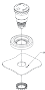
A: Bohrung für Kabeldurchführung
